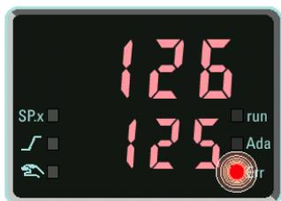
**维护管理器:**在错误信息列表中显示故障信号、警告和闭锁信息。闭锁的信号可以被手动复位。
